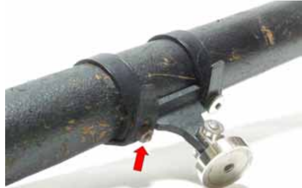
〔筒受のベルトを止める専用のナットがなくなっている〕
