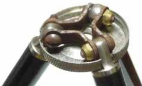
〔リーラ号に付属していた三脚の足の開閉機構〕
