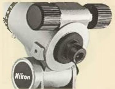
カメラアタッチメント：ニコンカメラを使っての天体写真撮影に欠かせないアクセサリーです。対物レンズの焦点位置に、カメラのフィルム面がくるようにする直焦点撮影。対物レンズとフィルム面の間に接眼レンズを入れた拡大撮影。この2通りの撮影にひとつのアタッチメントを使い分けることができます。直焦点撮影は月や星雲などの撮影に、また拡大撮影は月面の細部や惑星の撮影に適しています。
