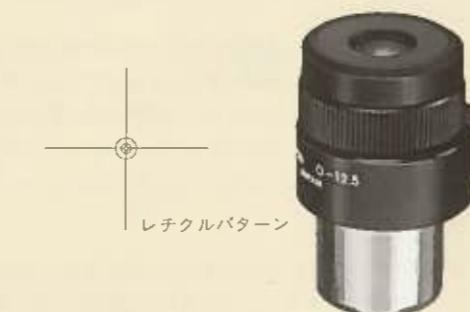
**案内用接眼レンズ**：星野写真撮影をするときに欠かせない案内用の接眼レンズ。O-12.5(C)に案内用レチクルを組み込んでいますので、目標の星を狂いなく撮影することができます。レチクルパターンの三重円は、10cm赤道儀と組み合わせた場合、内側からそれぞれ焦点距離200mm、100mm、50mmレンズまで。6.5cmの赤道儀では、焦点距離130mm、65mm、32mmレンズ(ともに35mmカメラ)までのガイド許容範囲を示しています(フィルム面上の0.02mmに対応)。暗視野照明ユニットの使用でレチクル照明も可能です。
