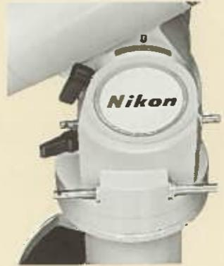
赤道儀架台は堅牢性を特に重視、確実なセッティングを行なえるようにしています。しかもニコン独自の微調整機構を内蔵。高度角は+10°~60°、方位角は±15°という広い範囲での微調整が可能です。別売の極軸望遠鏡を使用すれば、セッティングはより容易に正確に。また微動は、赤経・赤緯ともに、ウォームギアによる全周微動で両軸駆動の駆動装置を使用できます。赤緯目盛環は90°~0°~90°の目盛(最小目盛2°)になっており、0°は天の赤道を、90°は北または南の極を指示。指標はひと目でわかるよう、180°対称に刻んであります。また赤経目盛環は0~24時(最小目盛10')の恒星時目盛。駆動装置を作動させて天体を追尾する場合にも、赤経指標は常に目的の天体の赤経を表示し続けます。
