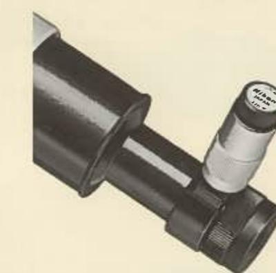
**暗視野照明ユニット**：極軸望遠鏡(10cm用)、案内用接眼レンズO-12.5(C)のレチクルを発光ダイオードにより暗視野照明。暗闇での極軸合わせや撮影も容易に行えます。ボリュームつまみの調節で、明るさの自由な選択も可能。電源には、リチウム電池(CR1/3N)を1個か、銀電池(G13)を2個使用します。
