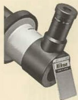
**サンプリズム**：太陽眼視観測の必需品です。太陽の光の95%を内蔵のハーシェルプリズム(透過率5%)を通して逃がし、そこで反射された残りの5%の光は、2枚のNDフィルターと熱線吸収フィルターでさらに減光されます。総合透過率は $1.6 \times 10^{-4}$ (1/625,000)。また、NDフィルターは内蔵されていますので、接眼レンズを交換するたびに、サングラスを換える手間がいりません。
