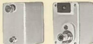
カメラアタッチメント：ニコンカメラで天体写真を撮影するときに用います。ひとつのアタッチメントで2通りの撮影が可能。月や星雲などには、対物レンズの焦点位置にフィルム面がくるようにする直焦点撮影を。また、月面の細部や惑星には、対物レンズとフィルム面の間に接眼レンズを介した拡大撮影を。拡大撮影では、さらに2通りの倍率を選択することができます。また、F3等ファインダースクリーンが交換できるカメラには、C型スクリーンが便利です。太陽の撮影には、必ず別売の太陽撮影用フィルターを併用してください。
