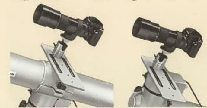
カメラ保持板：星野写真撮影の際に自由雲台を介して使うプレートで、2通りの使い方があります。①鏡筒バンド上部に取り付ける。②鏡筒バンドをはずして架台に取り付ける。どちらも2台のカメラ取り付けが可能です。また、マッチプレートとしても利用できますので、自作のガイド望遠鏡を同架するなど多目的に使用してください。
