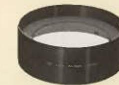
太陽撮影フィルター：太陽の写真撮影用フィルターで対物レンズフードを取りはずし、フード取り付けねじにねじ込み使用する対物用フィルター(ND400×)と、カメラアタッチメントに取り付けるφ52mmのND8×、ND400×の3種を用意。撮影条件により組み合わせて使用します。
