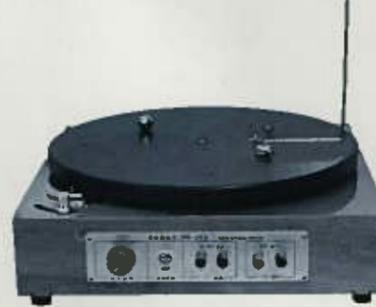
直径40cmの円盤が、モーターで回転を行ないます。高等学校の基礎理科教材として開発されたものですが、地学、物理の方面でも活用できます。特に地学方面では、テーブルの回転を地球の自転とみなし、フーコー振り子や、転向力(コリオリの力)の実験ができます。また、テーブルの中央に電源がとれる為ヒーターを置いて対流実験などが可能です。入力電源DC 0-3V ●正・逆転スイッチ ●速度調整ボリューム ●回転速度10-60rpm ●スリップリングとブラシによってテーブル上に電源がとれる ●フーコー振り子 ●コリオリ回転球
