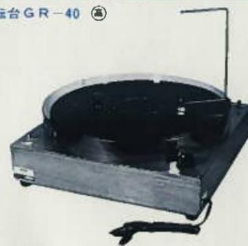
直径40cmの円盤が、モーターで回転を行ないます。高等学校の基礎理科教材として開発されたものですが、地学、物理の方面でも活用できます。特に地学方面では、テーブルの回転を地球の自転とみなし、フーコー振り子や、転向力(コリオリの力)の実験ができます。また、テーブルの中央に電源がとれる為ヒーターを置いて対流実験などが可能です。入力電源D.C.0-3V ●正・逆転スイッチ ●速度調整ボリューム ●回転速度10-60rpm ●スリッピングとブラシによってテーブル上に電源がとれる ●フーコー振り子 ●コリオリ回転球
