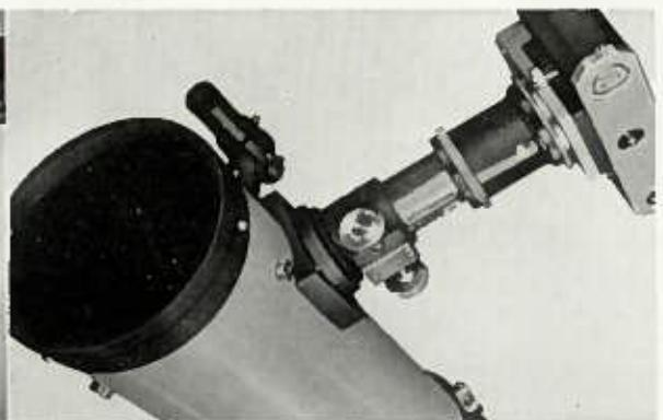
カメラのシャッターボタンはレリーズを使うことにより手で直接押すよりバイブレーションが少なくなります。
