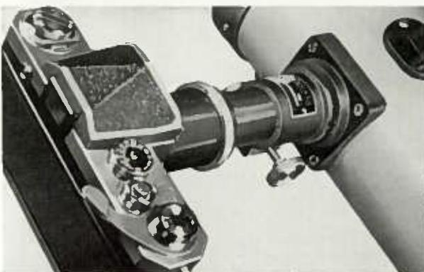
装着後、カメラ・ファインダーを覗きながら接眼部の微動ハンドルを静かに回しながら焦点像のピントを調整します。
