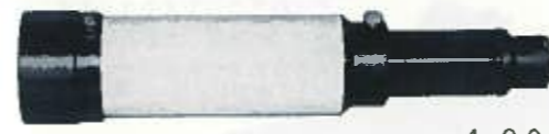
4,900円 A. アクロマート フルコート D60mm F300mm 天頂プリズム使用可能、接眼部24.5mm 36.4mm兼用ドロチューブを引出し、おおよそのピント調節後、上部のネジで固定、以後ピントは対物枠を回して行う。総金属製 全長30cm 重量450g (ガイド脚60付 6,900円)
